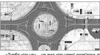
«Турбо-кільце» - це вид кільцевої розв'язки зі спіральними смугами руху, який передбачає можливість вибору необхідної смуги для проїзду що до в'їзду на кільце. Водіям рекомендуємо уважно визначити правильний вибір смуги, користуючись дорожніми знаками та горизонтальною розміткою.
